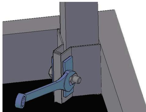
A continuación fije las **Uniones entre Módulos** mediante los **bulones** y ajuste con la llave.
